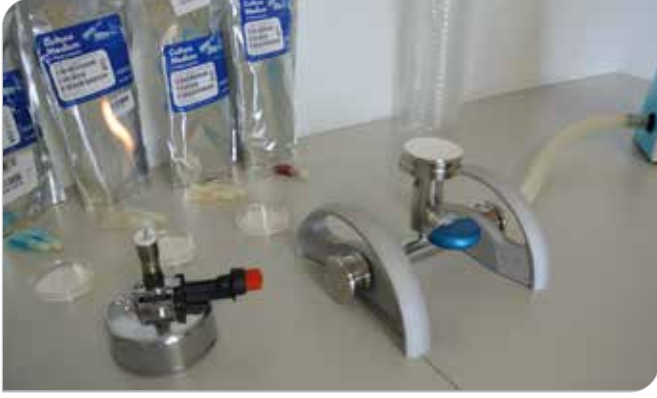
7. Adım: Çıkarılan filtre aseptik koşullarda manifold başlığına yerleştirilir.
