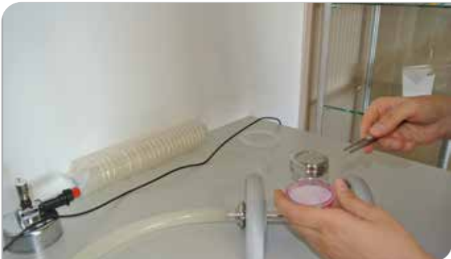
13. Adım: Alınan membran filtre daha önceden besiyeri emdirilmiş Petri-ped'e hava kabarcığı kalmadan düzgünce yerleştirilir.
