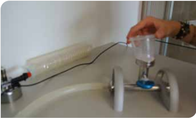
11. Adım: Süzme işlemi tamamlandıktan sonra analitik huni çıkartılır.
