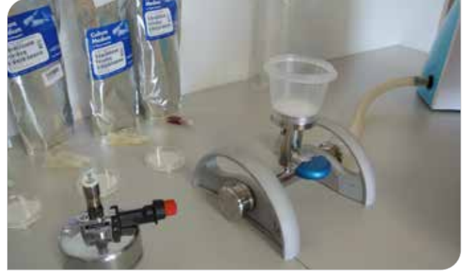
8. Adım: Filtre hunisi yerine yerleştirilir.
