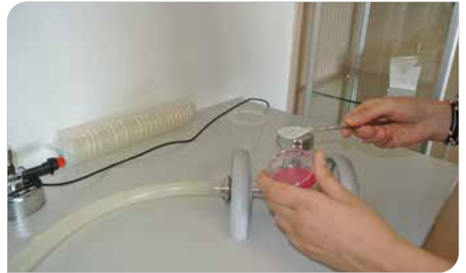
12. Adım: Manifold üzerindeki filtre bek alevinden geçirilmiş penset yardımı ile alınır.
