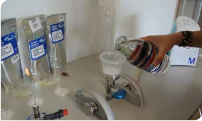
9. Adım: Analiz edilecek numuneden belirli bir hacim, aseptik koşullarda analitik huniye boşaltılır.
