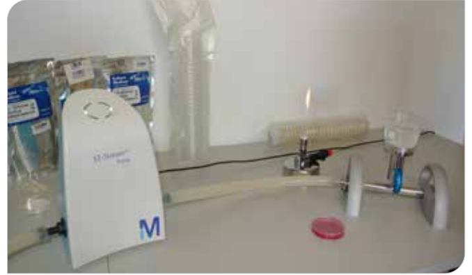
10. Adım: Vakum pompası çalıştırılarak vakum musluğu açılır ve numune filtre edilir.
